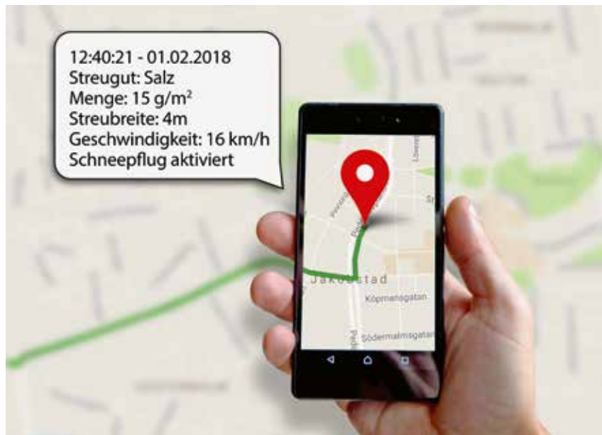
Die HTrack-Software von Hilltip zeichnet die Art des Streugutes, die Menge und sogar die Streubreite sowie Geschwindigkeit und Standort digital auf.
