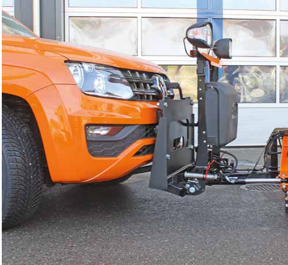
Die Schneepflüge können an Pick-ups, Traktoren und kleine LKW angebaut werden. Die Steuerungs- und Aufzeichnungs-Einheit ist im geschlossenen Gehäuse geschützt.
